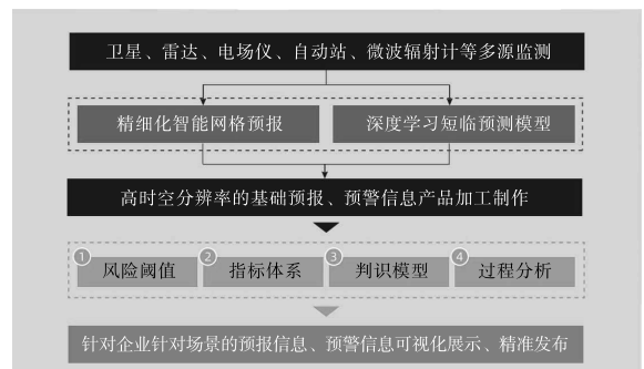
图 1 榆林能源化工智慧气象服务系统架构图
